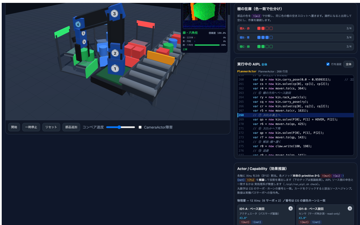
Figure 1: DOFBOT ライン作業シミュレータ（:8022）。2026-07-21 実行、node test/verify.mjs で全項目合格した状態。左は 3D の作業セル（銀色ホーンの丸数字が実機サーボ ID 1-6 に対応）、右上は手首カメラの映像と TinyML の分類結果（緑・六角柱 100 %）、中央右は実行中の AIPL ソースで、現在実行している行が強調表示される（PlannerActor 268 行目）、右下が Actor / Capability パネルで、各アクターの効果推論結果 !(mut) !(net) がチップとして表示される。
